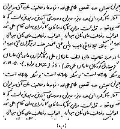
شکل ۳- الف) نرمال سازی فاصله بین کلمات، فاصله خطوط و پرکردن انتهای خطوط (ب) پرکردن بخش انتهایی تصویر (تصویر نهایی)
