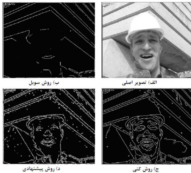
شکل ۱۵- مقایسه لبه‌های بدست آمده از چند روش با روش پیشنهادی
